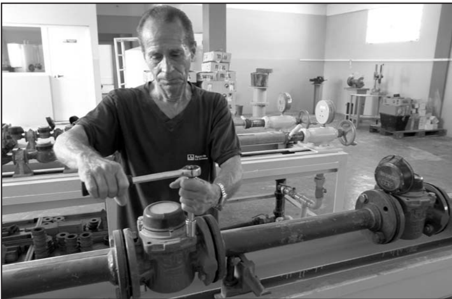
Francisco Hernández coloca contador de 50 milímetros en el banco de prueba
