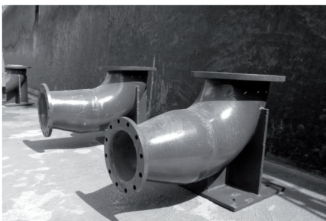
Codo que se acoplará a la descarga de la bomba sumergible.
