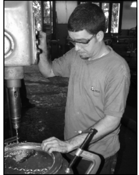
René Vázquez barrenando platillo de bomba de agua.
