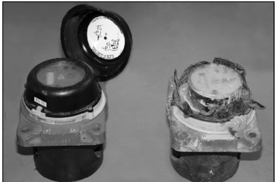
Metrocontador reparado y su estado anterior.
