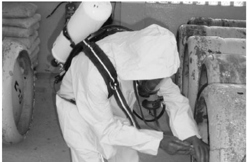
Manipulación de válvula defectuosa en cilindros de cloro.
