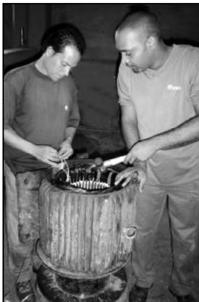
Rey J. Guerra, enrollador «B» y Roberto Au, enrollador «C», bobinando un motor de Santa Fé.
